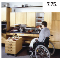
7.75. ÁBRA Állítható magasságú munkafelület és leengedhető felső szekrény. A gördülő tárolóbútorok segítségével gazdaságosan használható a térdszabad munkalap alatti tér, s könnyen a helyet bezárható alakítható a munkafelület
