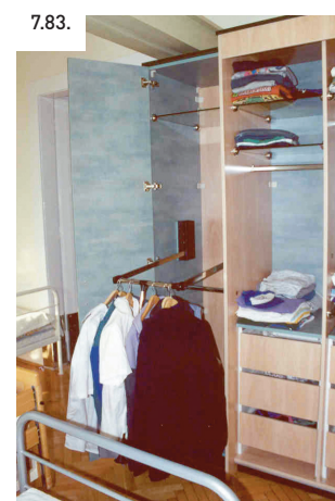
7.83. ÁBRA Gardrób szekrény magasabb akasztós részének akadálymentes elérhetősége speciális bútortámaszokkal
